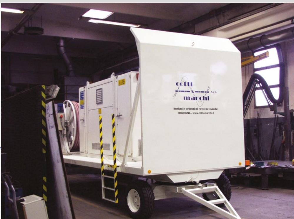
**LA CABINA BLINDATA**, quando opera in ambienti con un fondo uniforme, può essere installata su carro gommato contenente anche l'avvolgicavo motorizzato di media/bassa tensione.
